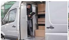
Bodenbelag, Wandverkleidung und Trennwände. Ein hochwertiger Boden-belag verbessert die Ergonomie und stärkt das Image Ihres Unternehmens. Eine Wandverkleidung im Innenraum beugt einem Verschleiß des Laderaums vor. Eine Trennwand stellt eine kostengünstige Lebensversicherung dar. Sie verhindert, dass Werkzeuge und andere Materialien bei starken Bremsvorgängen oder Unfällen in den Fahrerbereich geschleudert werden.
