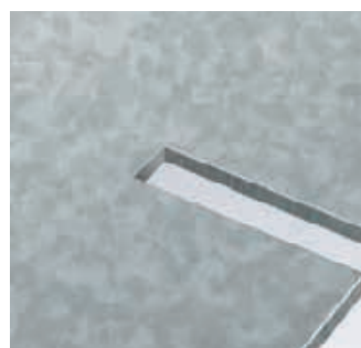
Ausklinken und Spanbrechen in einem Arbeitsgang
