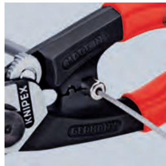
Anpressen der Endhülse an die Bowdenhülle
