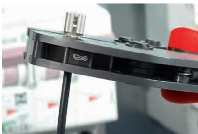
Gut sichtbare Kennzeichnung der Crimpeinsätze mit Piktogrammen
