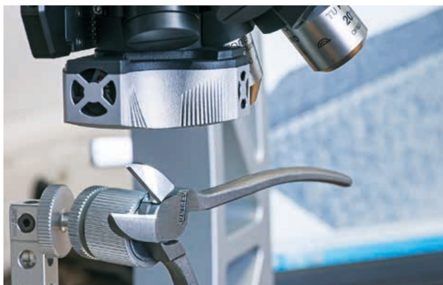
Beim Seitenschneider werden die Form und die Rauheit der Schneide mit einem optischen 3D-Messsystem präzise vermessen.
