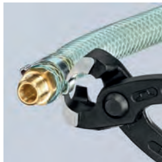
Abdichten Pneumatikschlauch an Schnellkupplung
