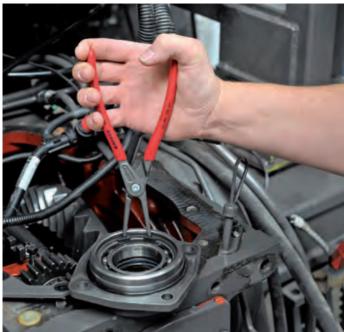
Stabile, eingesetzte Spitzen aus hochverdichtetem Federstahl
