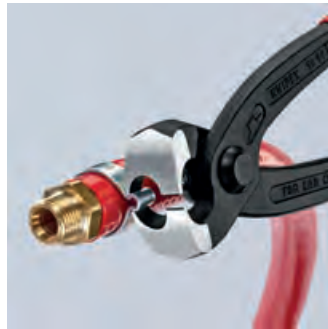
Abdichten Fluidschlauch an Stutzen mittels Seiten-Pressnase
