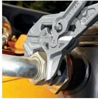
Ersetzt einen Satz Schraubenschlüssel, metrisch wie zöllig
