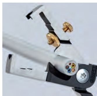
Induktiv gehärtete Scherschneide mit Präzisionschliff zum quetschfreien Schneiden von Cu- und Al-Kabeln bis Ø 15 mm (5 x 2,5 mm 2 )
