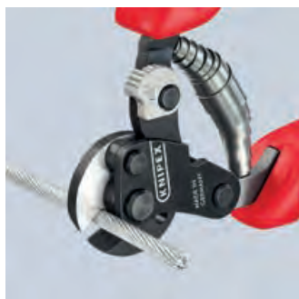
Schneiden von hochfesten Drahtseilen (1960 N/mm 2 ) bis \varnothing 4 mm
