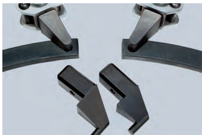
Wechselbare Einsätze für Innen und Außenringe
