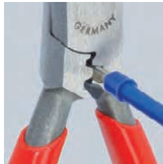
Crimpen 0,5 bis 2,5 mm 2
