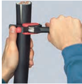
Drehen des Werkzeugs für Umfangsschnitt
