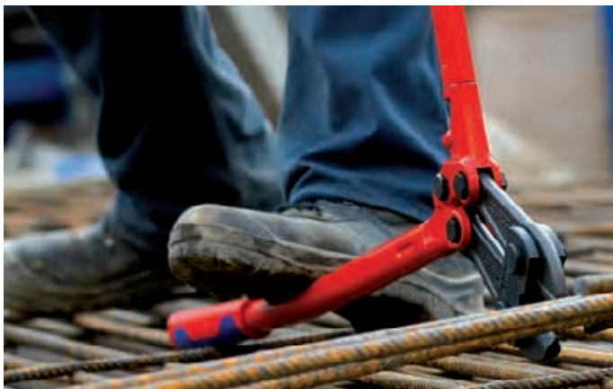
Angeschmiedeter Anschlag mit Dämpfungs-Einsatz: dämpft den Schnittschlag komfortabel ab
