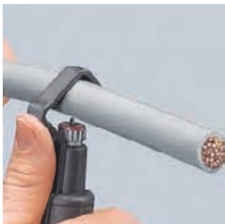
Ansetzen des Werkzeugs für Umfangsschnitt
