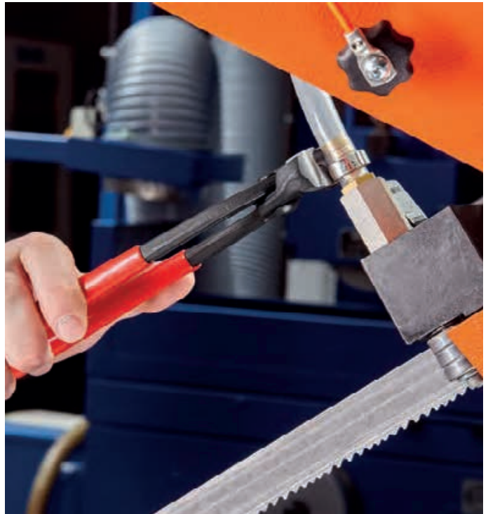
Abdichten Fluidschlauch an Stutzen mittels Seiten-Pressnase
