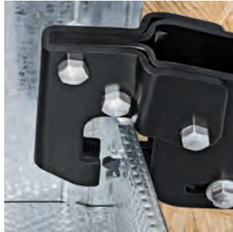
Ansetzen der Zange an zwei zu verbindenden Profilblechen
