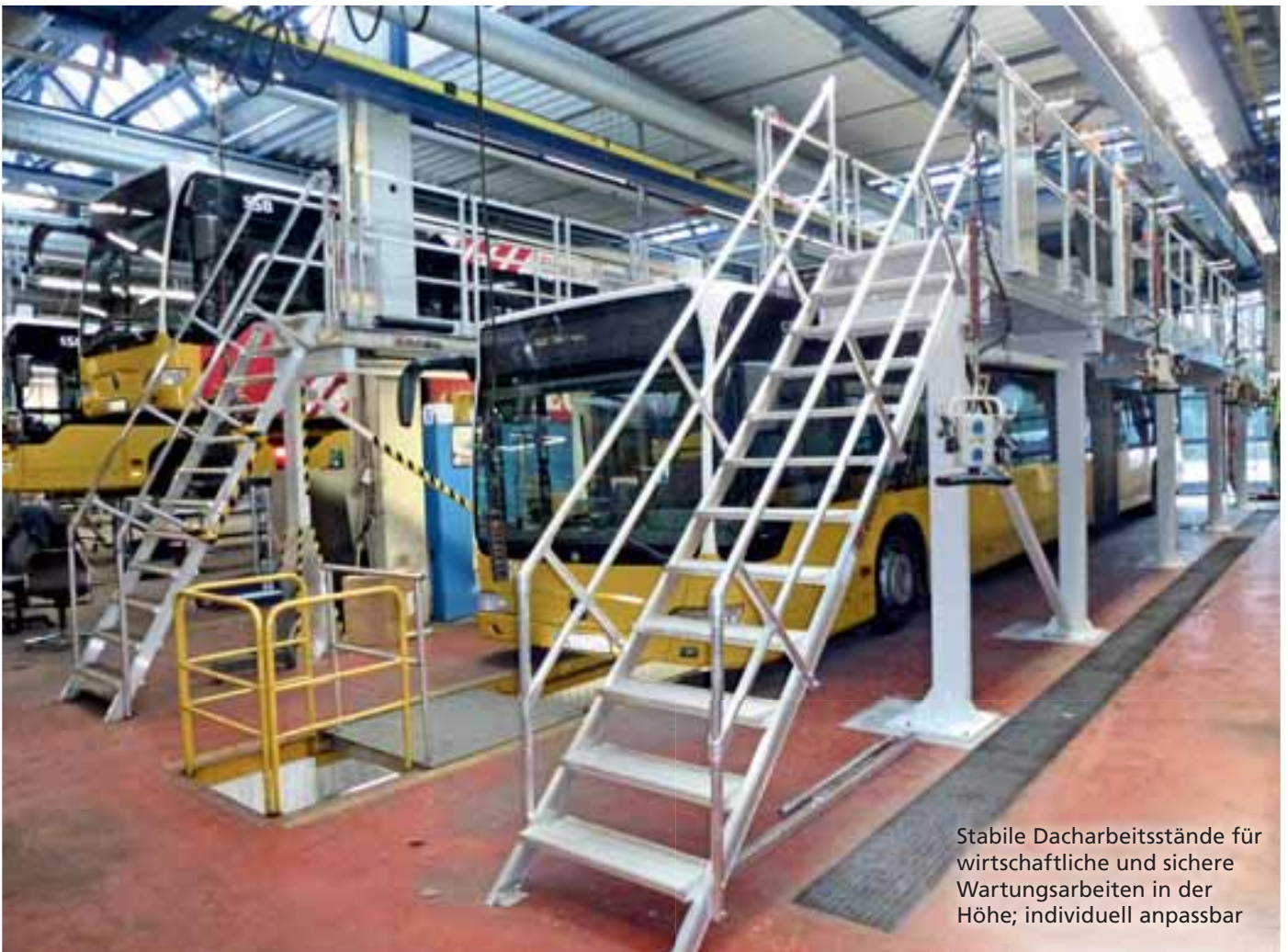
Schnell und garantiert sicher: Wartungsbühne mit Zentralfeststellung
