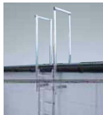
Anbausatz zum Ausstiegsholm 4) Einseitig, zum Anbau an vor- handenem Ausstiegsholm (s. Baukastenelemente). Bestehend aus Handlauf 500 mm und Stützteil 1200 mm mit Bodenwinkel.
