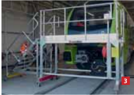
3. Mobile Frontarbeitsbühne für geschütztes Arbeiten im Front- und Stirnbereich
