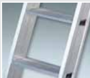
Stufen mit 80 mm waagerechter Auftrittsfläche für sicheren und ermüdungsfreien Stand, Stufenabstand 250mm
