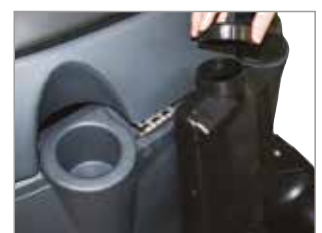
GETRENNTES DOSIERSYSTEM FÜR REINIGUNGSMITTEL
