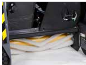
HAUPTKEHRWALZE MIT V-FÖRMIGEN BORSTEN
